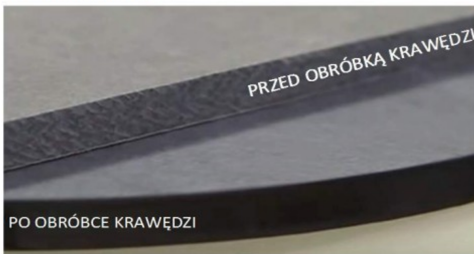
Rys.10 krawędzie przed i po polerowaniu
