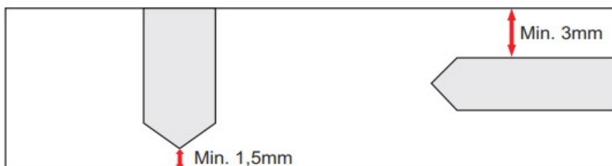
Rys.2 Odległość otworów od krawędzi
